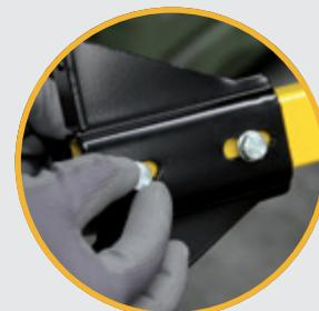
La base assemblata regolabile permette fino a 3 cm di compensazione dei dislivelli delle pavimentazioni
