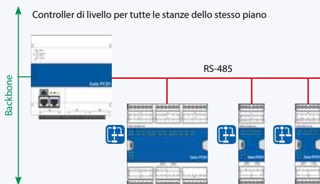
Tutti i moduli sono liberamente programmabili e operabili come "stand alone". Lo scambio dati avviene tramite connessione RS-485 e un accoppiatore di rete, per esempio un controller di livello.
