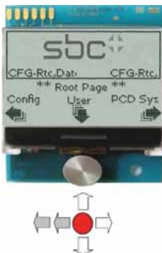
Manopola di comando a 5 vie per la configurazione, la modifica dei progetti utente e per le impostazioni del sistema PCD, come tipo di CPU, data e ora, indirizzo TCP/IP ecc.
