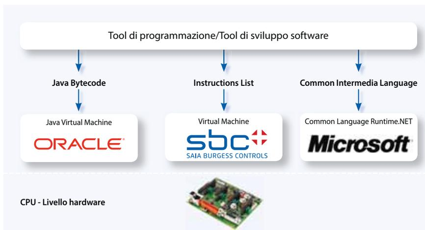
▲ Forniamo i nostri dispositivi con una macchina virtuale MCR. Questa «macchina» rimane sempre la stessa, anche se cambia l'hardware sottostante. La vostra applicazione funzionerà su tutte le piattaforme dei dispositivi, ora e in futuro.
