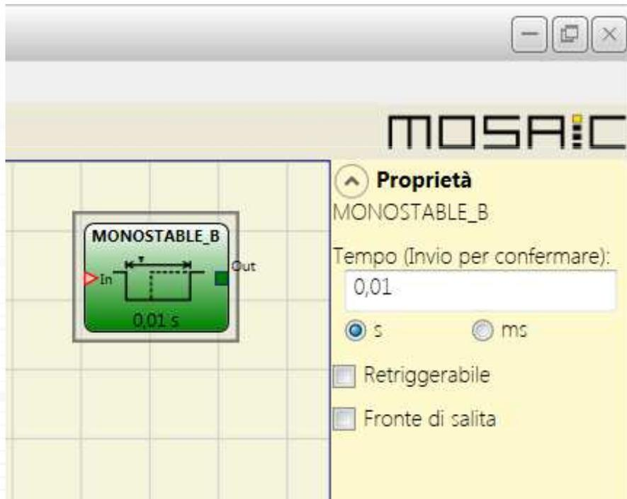
Questo operatore fornisce in uscita OUT un livello alto (1) attivato dal fronte di salita/discesa dell'IN e vi **permane per il tempo  $t$  impostato**.
