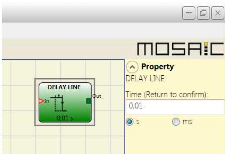
Questo operatore inserisce un ritardo ad un segnale portando a 0 l'uscita OUT dopo il tempo impostato a fronte di una discesa del segnale IN.
