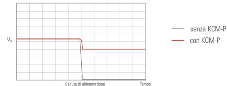
Tensione sul circuito intermedio in corrente continua in caso di caduta di alimentazione
