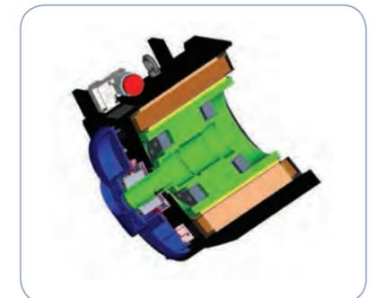
Struttura di un motore Cartridge DDR (CDDR)
