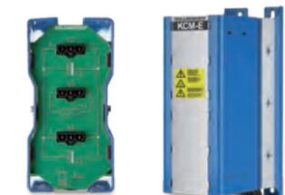
Con i moduli di espansione KCM-E è possibile incrementare la riserva di energia in maniera praticamente illimitata. In ogni modulo è integrata una resistenza di scarica. Il collegamento avviene attraverso i cavi a polarità obbligata in dotazione mediante connettori ad innesto sul lato superiore dei moduli.
