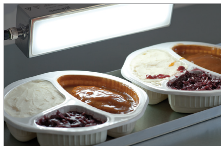
V4A-Aufflichtbeleuchtungen zur Qualitätsüberwachung in der Lebensmittelindustrie (BEK 1-A xxxV ...)
