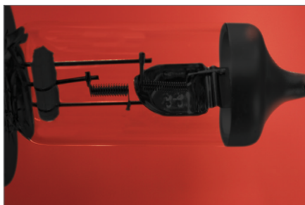
Flächenbeleuchtung zur Konturüberwachung an Metallteilen (BEK-F ...)
