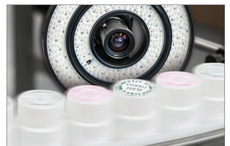
Hochgeschwindigkeitsetikettenkontrolle mittels geblitzter Ringbeleuchtung (BE-R ...) High-speed label inspection with flashed ringlights (BE-R ...)
